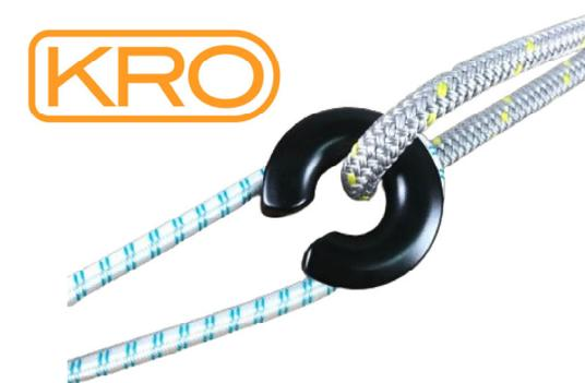
Les anneaux à friction ouverts permettent d'aligner parfaitement la drosse dans la roue crantée de l'emmagasineur et le long des chandeliers. Les emmagasineurs sont par définition amovibles et les anneaux ouverts permettent d'installer et d'enlever rapidement la drosse.
